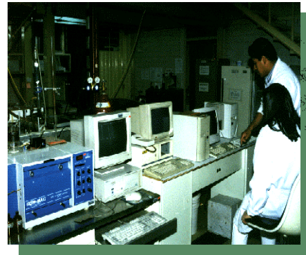
Muestreo de CO 2 , O 2 y T°C en cromatógrafo de gases Gow-Mac
