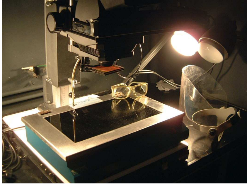
Figure 32: Installation de visualisation sous UV avec appareil de photographie instantanée du type Polaroid.
