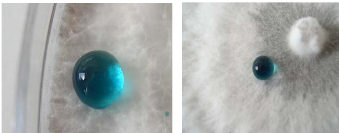
Figura 20. Actividad lacasa cualitativa sobre micelio de Pleurotus spp. crecido sobre extracto de pulpa de café con glucosa, lateral (A) y centro de la placa (B).
