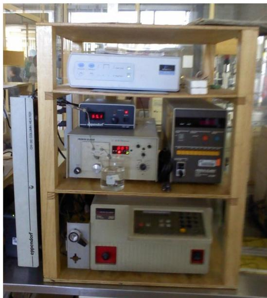
Figura 6.4. Equipo HPLC utilizado para determinar monómeros (C<sub>5</sub> y C<sub>6</sub>) e inhibidores.
