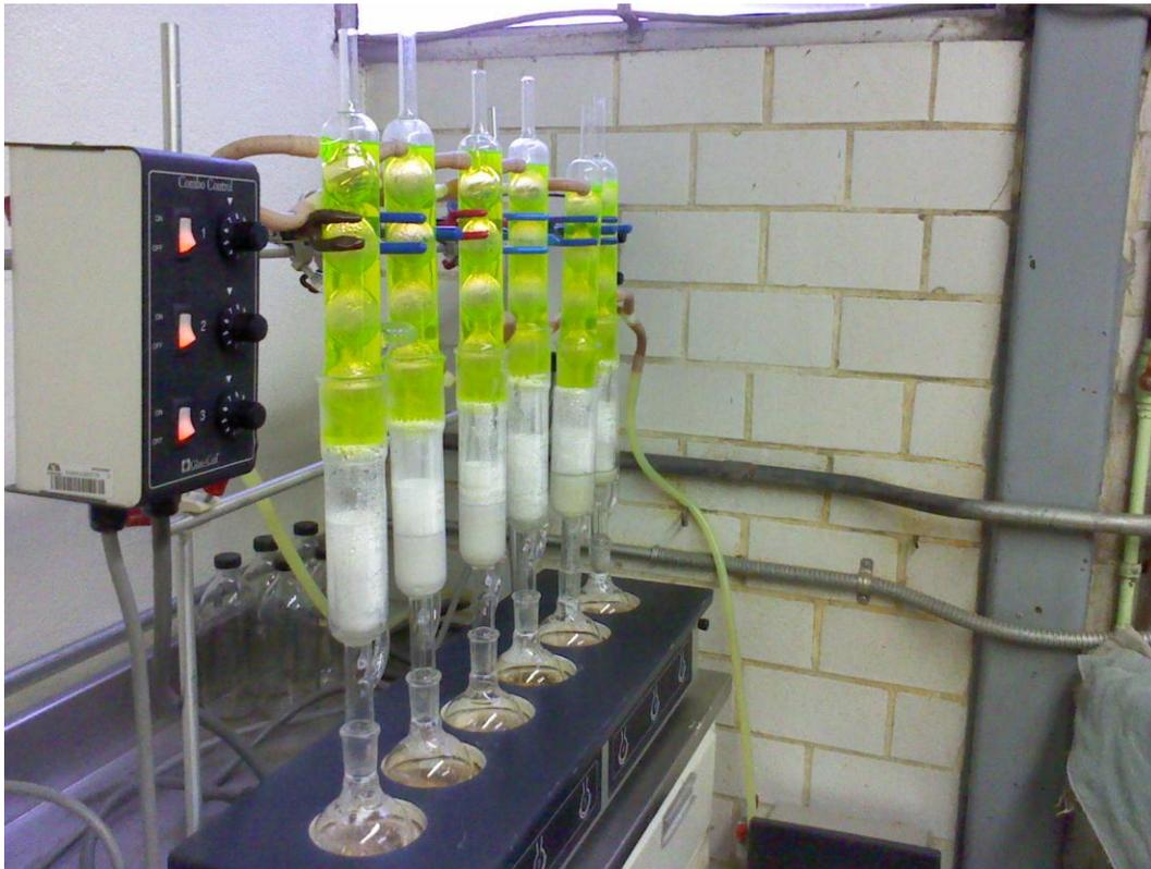
Figura 6.3. Método de Soxhlet para determinación de extractivos.
