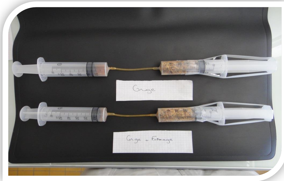
Figure 3-3: Photo du dispositif d'un microsilo expérimental pour l'ensilage.
